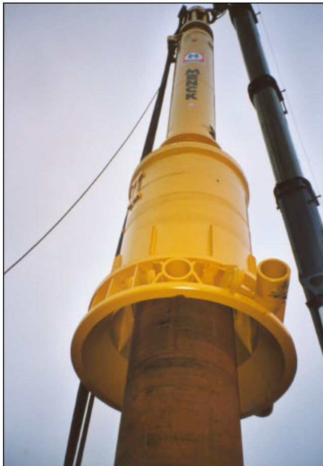
Bild 10: Offshore-Rammhammer, Typ MHU 500 T der Fa. Menck
